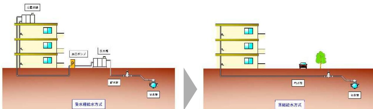
図2-4 直結給水方式への転換イメージ
