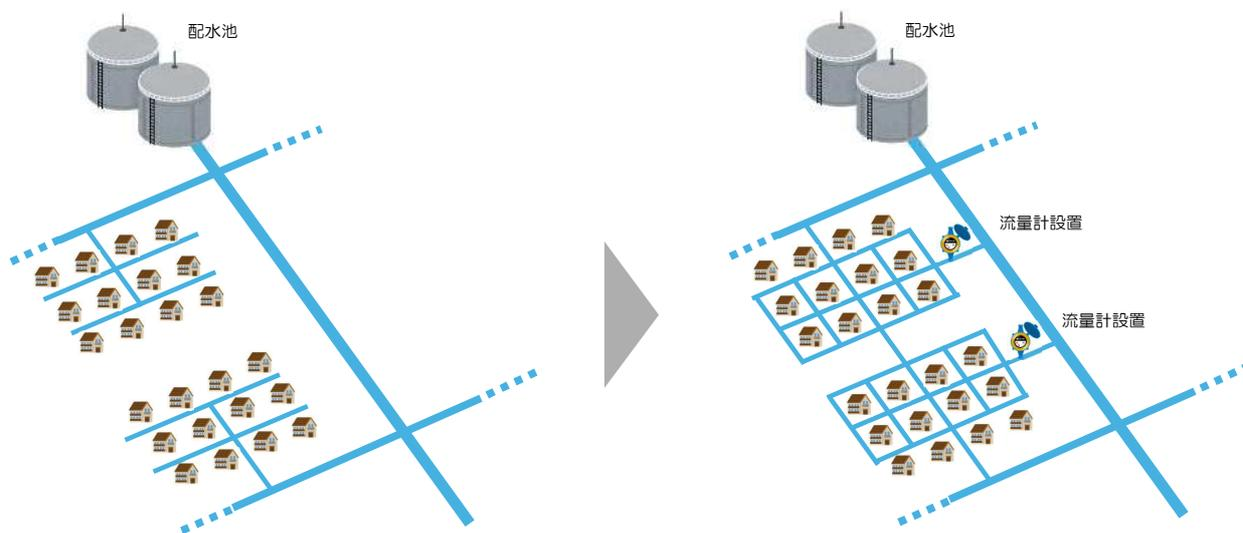
図4-1 配水管網のループ化イメージ
