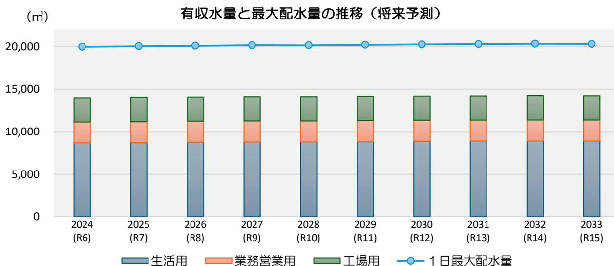
図3-4 有収水量と最大配水量の推移（将来予測）
