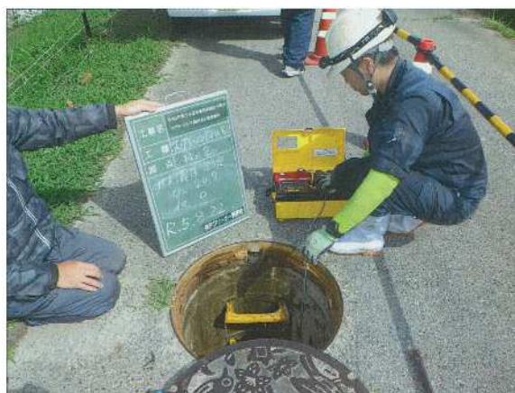
不明水調査（TVカメラ調査及びスクリーニング調査）の様子
