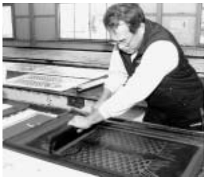
型枠を用いた「捺染染め」。この製法により大量生産が可能となりました。
