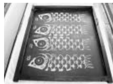
型枠を用いた「捺染染め」。この製法により大量生産が可能となりました。
