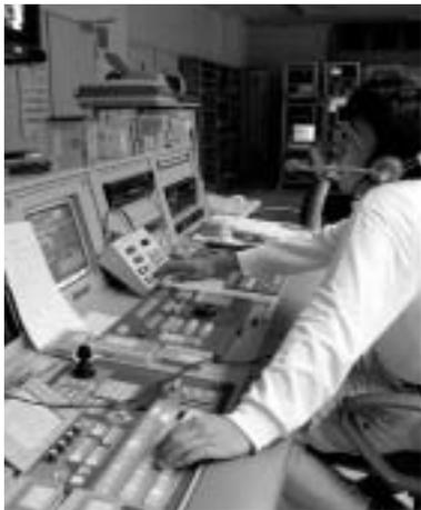
情報センターでは、スイッチャーが、中継車から送られてきた映像、VTR、スタジオのキャスターの映像などを切り替え、テロップなどを挿入して各家庭に送る映像を制作します。
