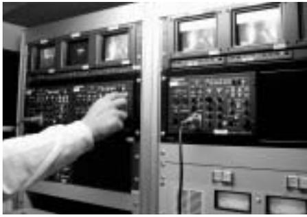
中継車の中で、スイッチャーが、どのカメラの映像を情報センターに送るかを選びます。
