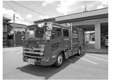
▲水槽付き消防ポンプ自動車 (タンク車)
