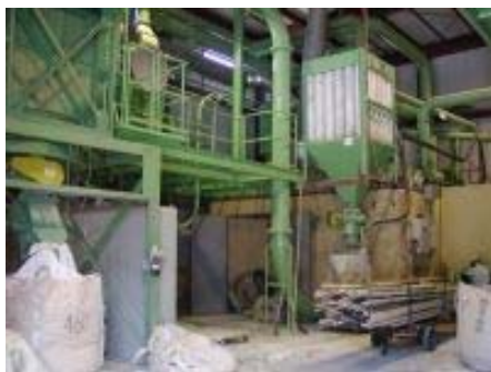
ひょうごバイオマス eco モデルに登録された(株)宮下木材の粉体化施設 （廃木材の粉体化による建築資材等の製造）
