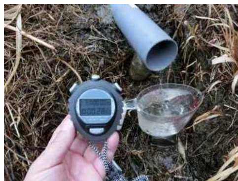
後法 漏水量測定(近景)
