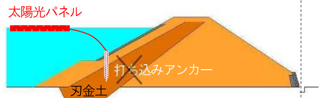
ため池の断面図(傾斜コア型)
