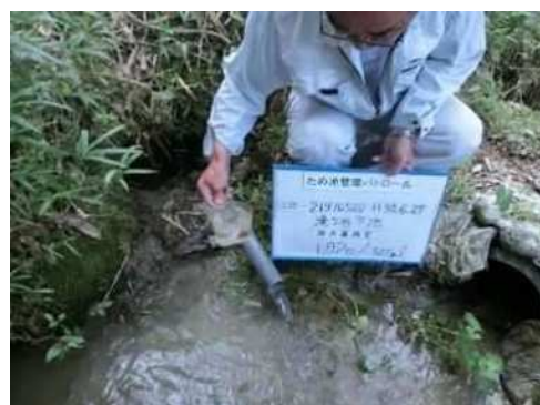
後法 漏水量測定(遠景)
