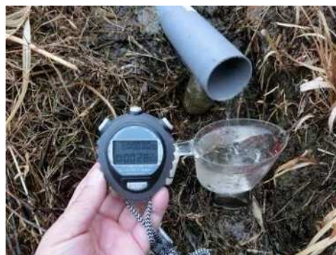
後法 漏水量測定(近景)
