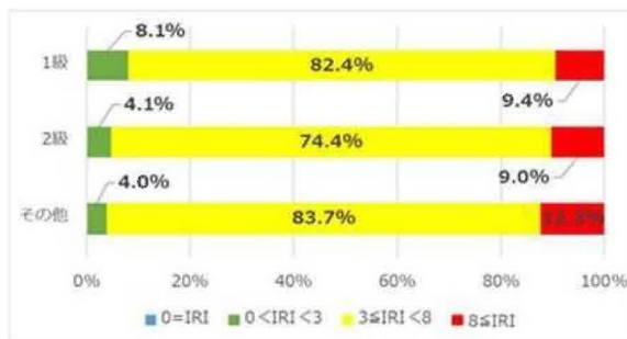
図 8 縦断凹凸（IRI）の状況
