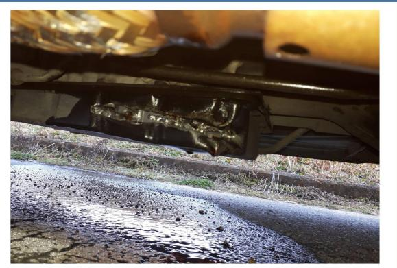
(車両底面部が損傷)
