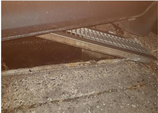
(車両底面にグレーチングが刺さっている状況：運転席側より撮影)
