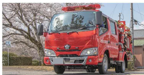
小型動力ポンプ付積載車
